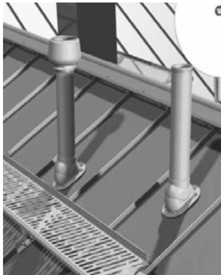
Kuva 39. Läpivientielementtien sijainti lappeella.
